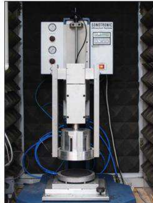
Verschweißen mit Ultraschall
